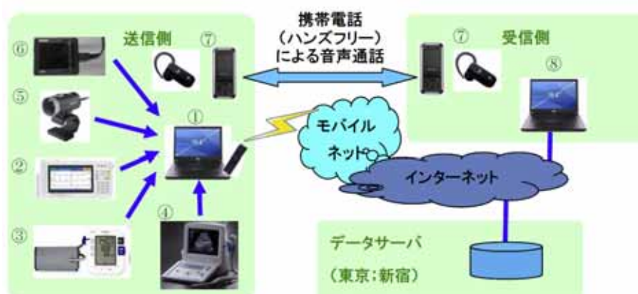
図 3.1.2-1 実証実験に使用した画像伝送システム P2 の基本構成
